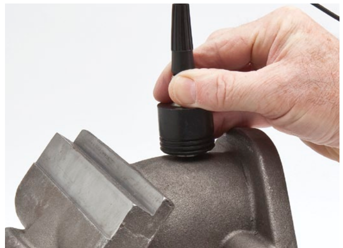
Plusieurs pièces de fonte ou matériaux à forte atténuation peuvent être mesurées à l'aide de l'option logicielle haute pénétration
