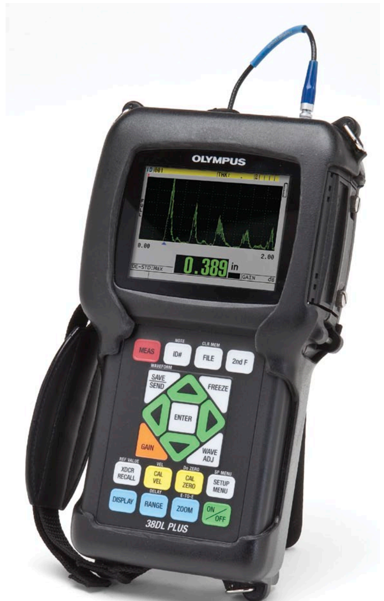
Appareil 38DL PLUS avec étui de protection standard en caoutchouc
