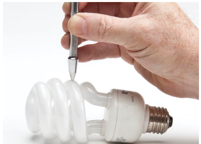
L'option logicielle haute résolution permet d'effectuer des mesures d'épaisseur jusqu'à une résolution de 0,001 mm
