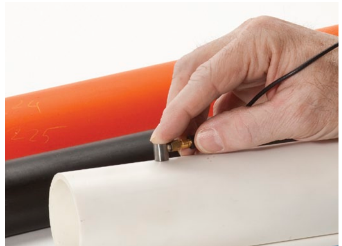
Mesure de l'épaisseur de nombreux matériaux incluant le plastique, le caoutchouc, le verre, la céramique et les composites
